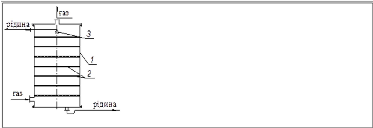
Рис. 2.21. Тарічаста колона без зливних механізмів: 1 – колона; 2 – тарілки; 3 – розподільвач рідини
