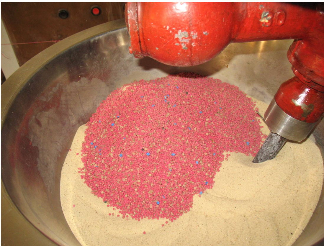
Рисунок 4.6 - Процес змішування без додаткового розподільного елемента (первинне завантаження).
