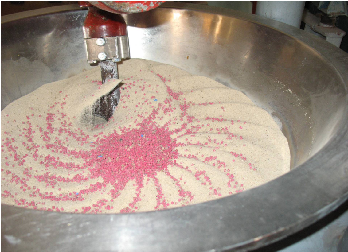
Рисунок 4.7 - Змішування без додаткового розподільного елемента після 6 обертів водила
