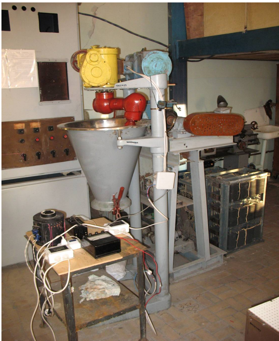
Рисунок 5.4 - Змішувач ПШ-24 (модернізований планетарно-шнековий змішувач фірми «Nauta» (Нідерланди).
