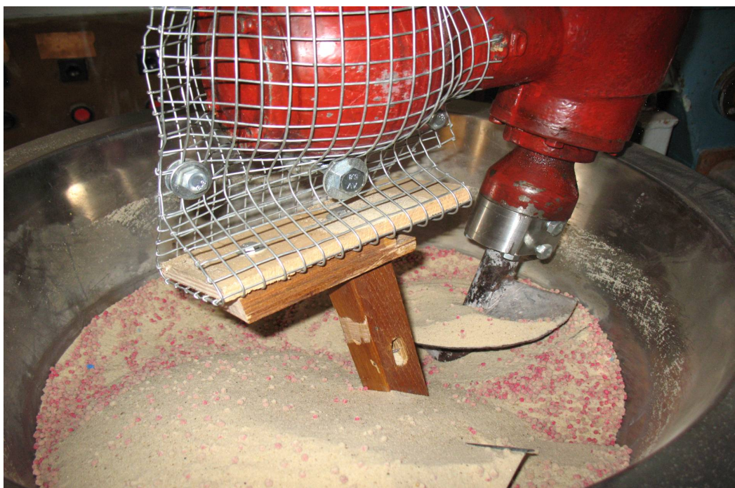
4.9 - Розподілення компонентів в змішувачі з додатковими розподільними елементами після 4 обертів водила
