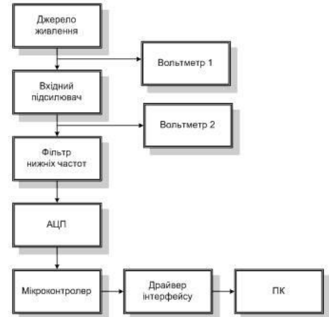
Структурна схема визначення впливу частоти зрізу ФНЧ на вході АЦП на основну похибку компонентів каналу обробки аналогових сигналів ІВС
