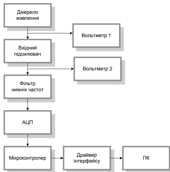
Рисунок 2.2 – Структурна схема визначення впливу частоти зрізу ФНЧ на вході АЦП на основну похибку компонентів каналу обробки аналогових сигналів ІВС
