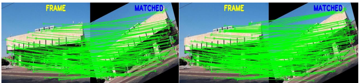
Рисунок В.1 –Відповідності дескрипторів SURF при повороті, де \alpha=20
