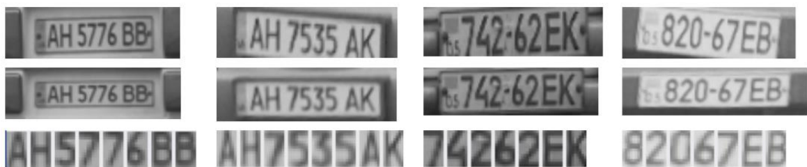
Рисунок 2.9 – Приклади роботи алгоритмів нормалізації зображення номера і сегментації символів
