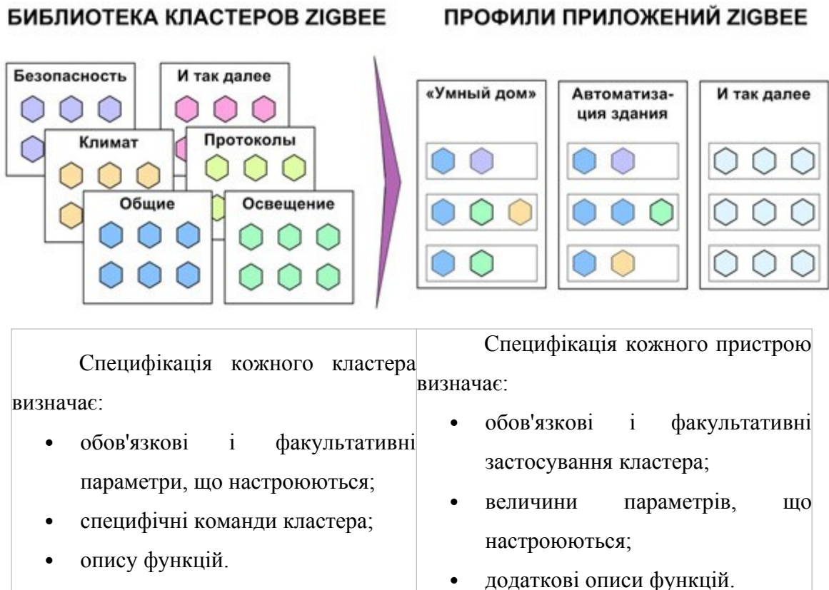
Рисунок 2.13 - Бібліотеки кластерів і профілі додатків ZigBee
