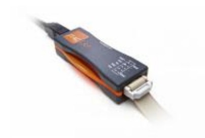
Рисунок В.1 - Контролер JTAG Live
