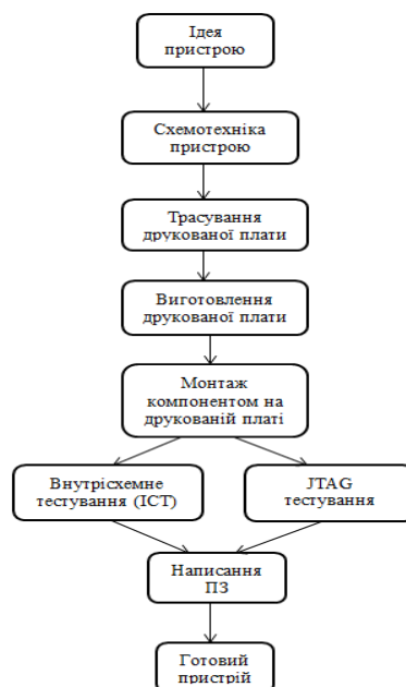
Рисунок 3.17 - Місце JTAG-тестування в загальному процесі виробництва
