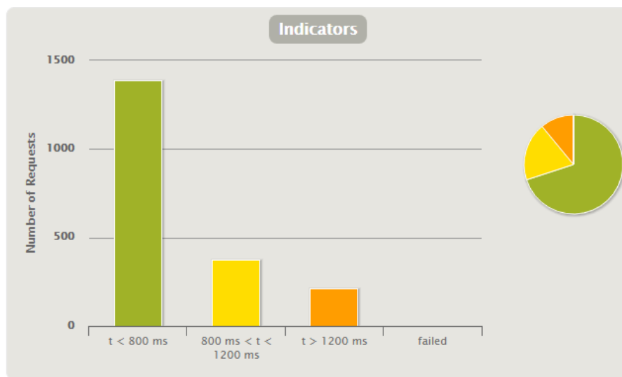
Рисунок 4.3 – Звіт «Indicators Graphic» на первинній версії системи при імітуванні паралельної роботи 20 користувачів
