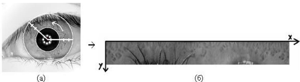
Рисунок 4.4 - (а) - зображення ока з введеною псевдополярною системою координат; (б) нормалізоване зображення райдужної оболонки
