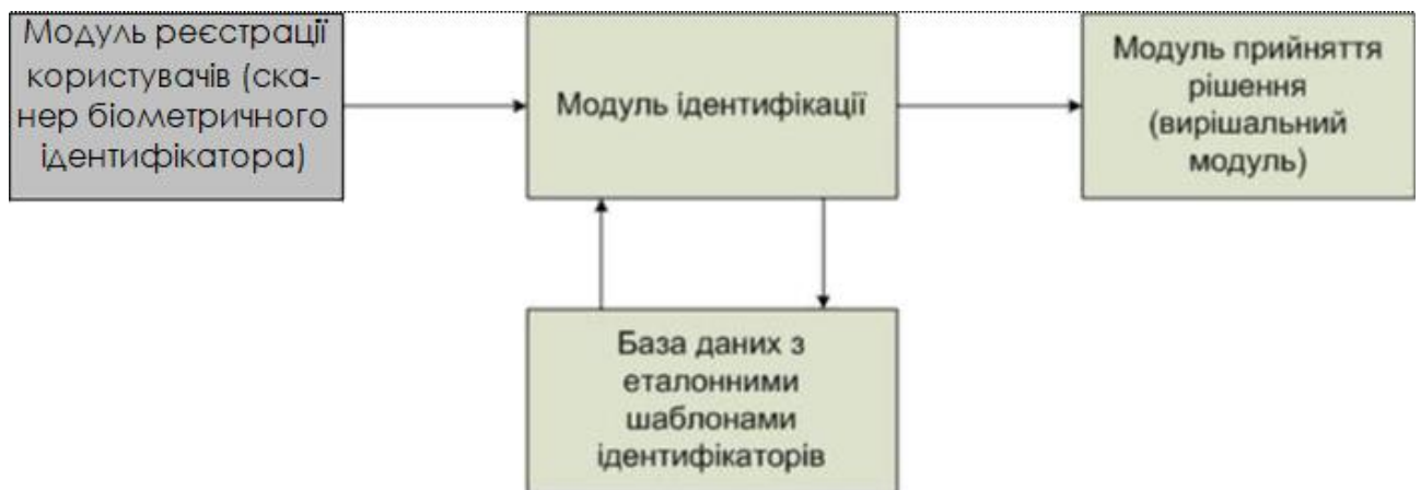
Рисунок 2.2 – Спрощена структурна схема системи біометричної ідентифікації
