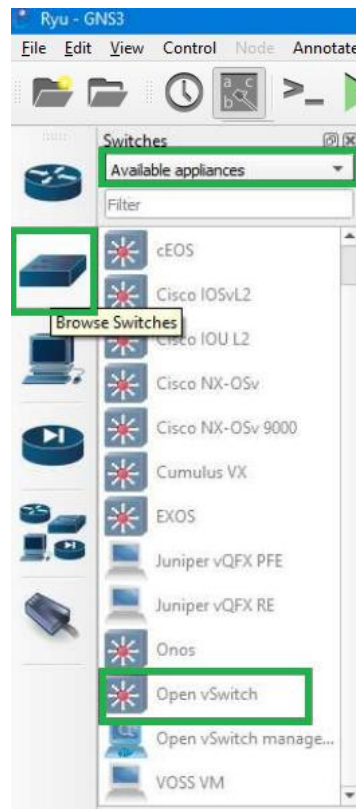
Рисунок 3.10 – Додавання комутатора Open vSwitch
