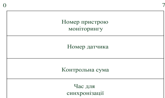
Рисунок 3.5 – Формат пакета запиту, надсилається сервером при опитуванні пристроїв моніторингу
