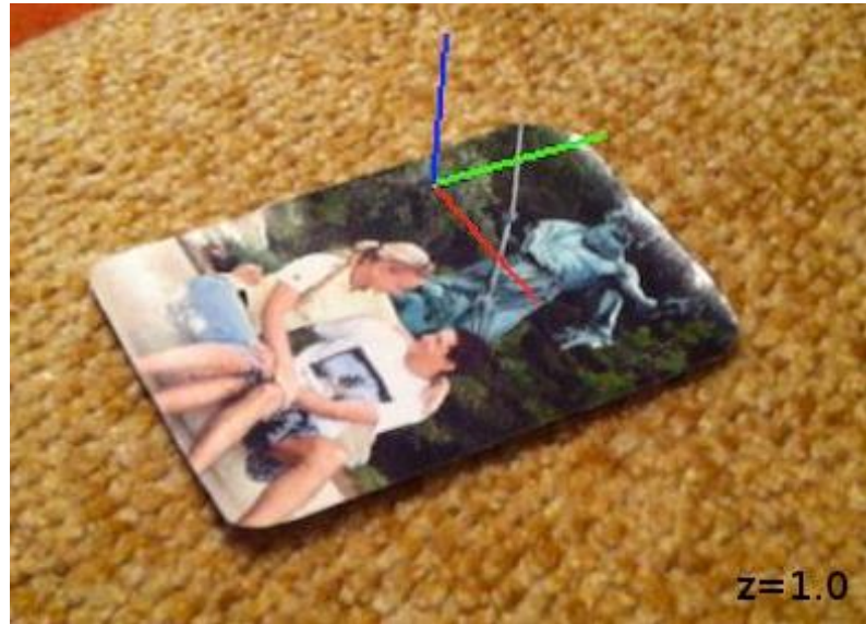
Рисунок 4.8 – Розміщення об'єкту на маркері з напрямками осі координат
