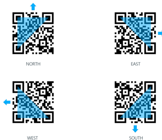
Рисунок 4.3 – Приклад визначення орієнтації QR-коду за трьома точками
