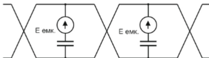
Рисунок 2.2 – Схема знищення перешкод за допомогою крученої пари
