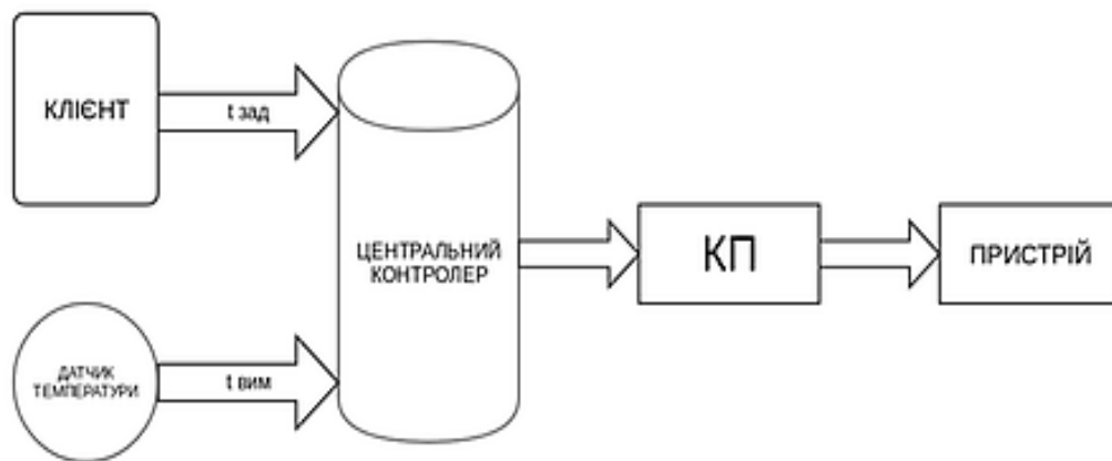
Рисунок 2.1 — Алгоритм функціонування системи керування температурою
