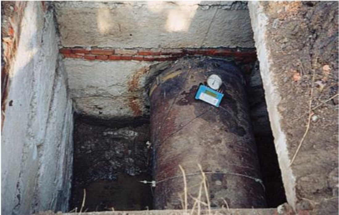
Рисунок 2.2 - Вимірювання швидкості і витрати води в водогоні
