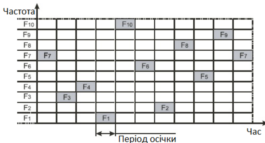
Рисунок 1.10 – Принцип дії алгоритму Frequency Hopping Spread Spectrum
