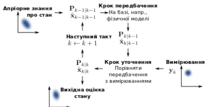
Рисунок 1.12 – Принцип дії фільтра Калмана
