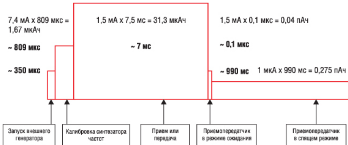
Рисунок 2.8 – Приклад профілю енергоспоживання безпроводного вузла
