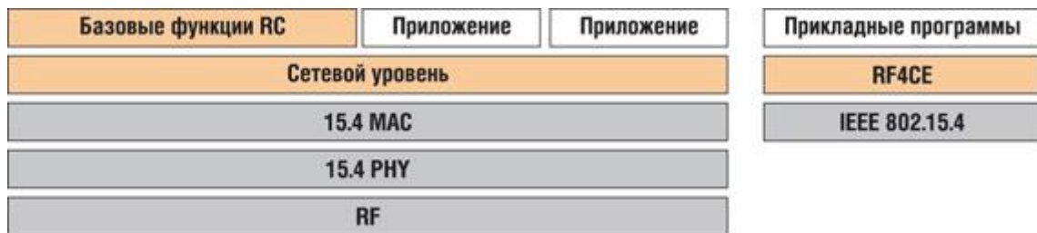
Рисунок 2.10 – Структура стека протоколів RemoTI
