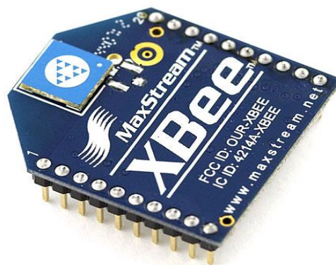
Рисунок 4.1 – ZigBee модуль XB24-ACI-001
