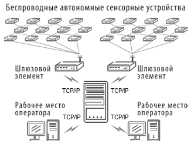
Рисунок 2.1 – Система збору телеметричної інформації на основі БСМ
