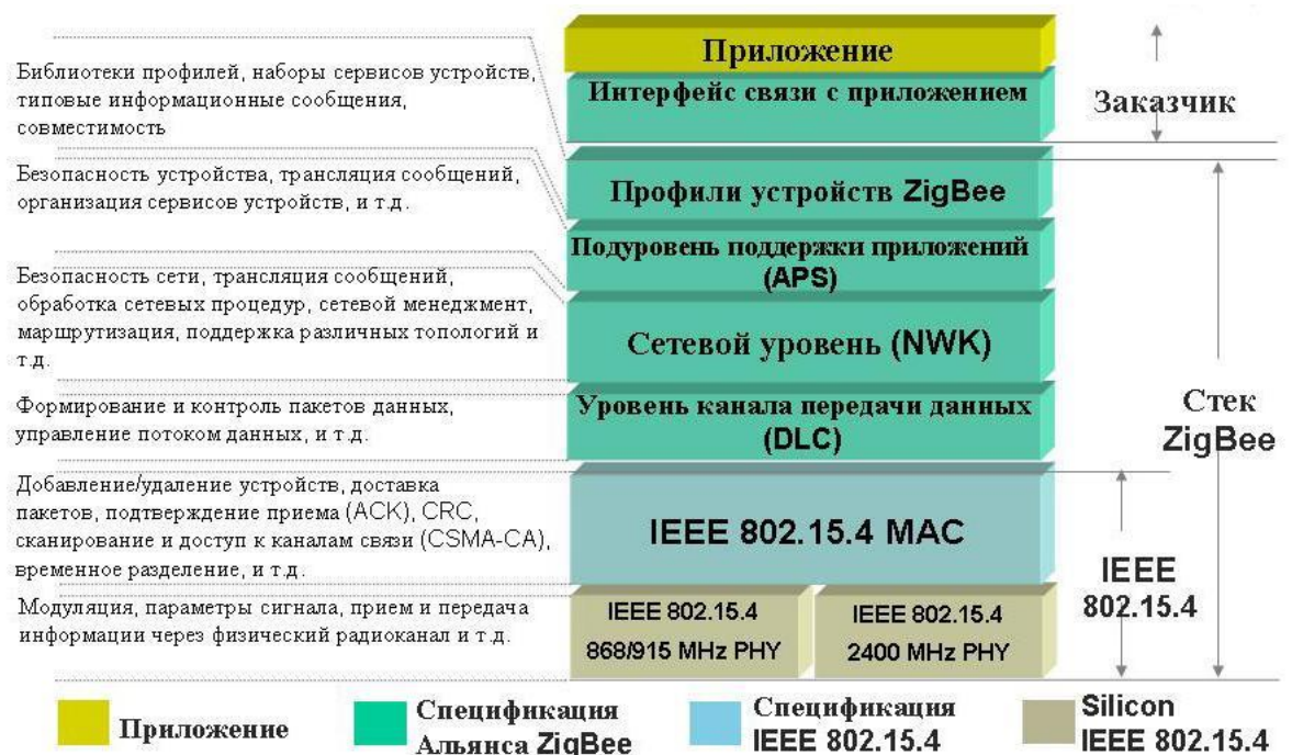
Рисунок 2.5 – Конфигурация стеков протоколов 802.15.4 и ZigBee
