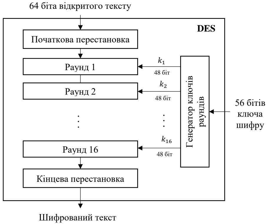
Рисунок 2.3 – Схема шифрування алгоритму DES
