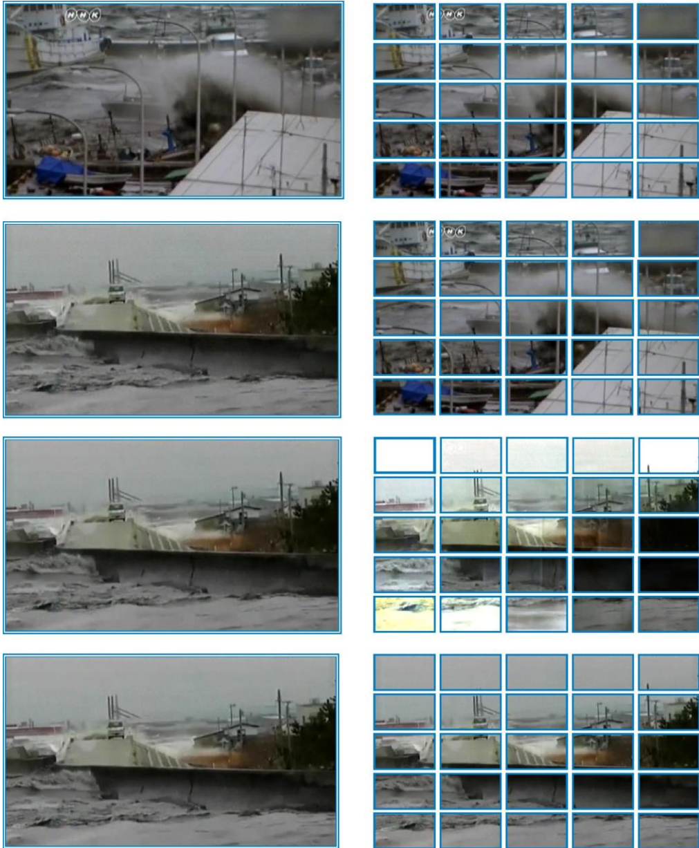
Рисунок 3.13 – Приклад блочного прогнозу меж відеосегменту на 457-460 кадрах тестового відеоряду
