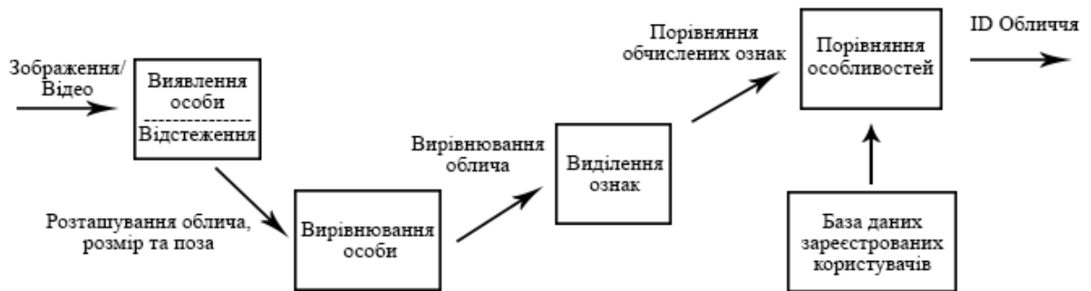
Рисунок 1.4 – Загальний процес обробки зображення особи при розпізнаванні
