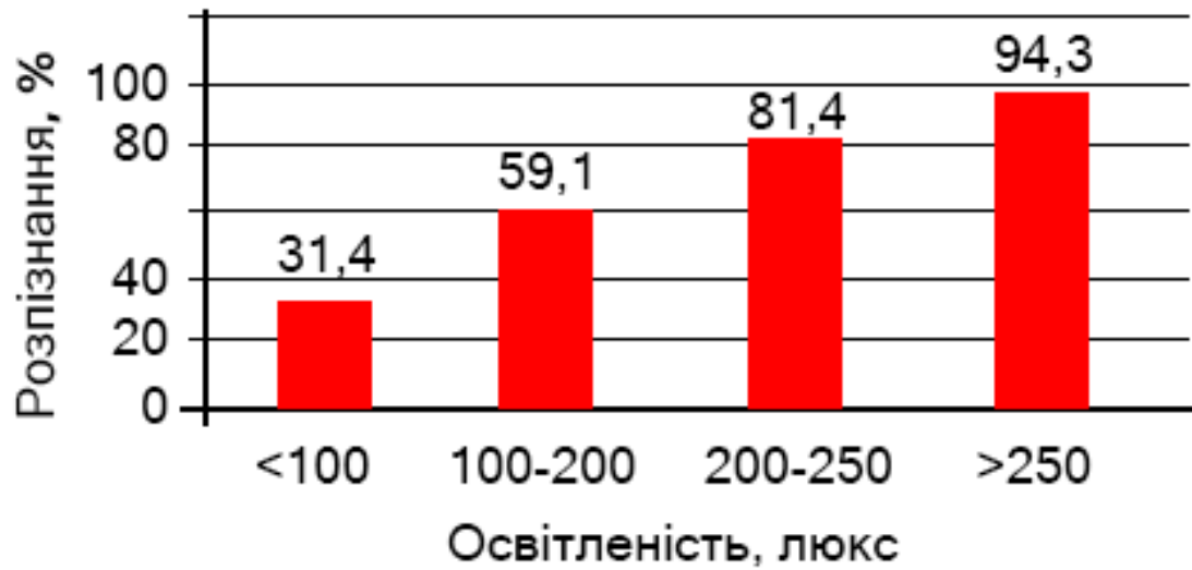
Рисунок 3.5 – Діаграма залежності розпізнавання від освітленості
