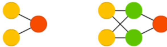
Рисунок 1.1. Архітектура ШНМ прямого поширення
