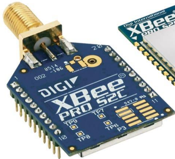
Рисунок 2.6 – Модуль XБee з розширеним діапазоном
