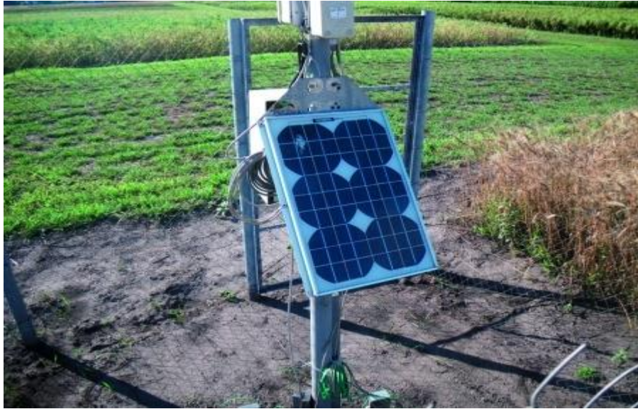
Рисунок 1.4 - Приклад комплектації професійної метеостанції сонячною батареєю.
