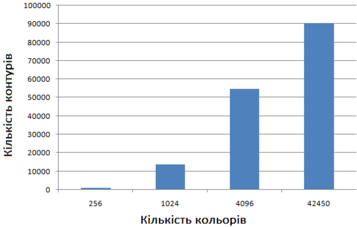
Рисунок 3.5 – Діаграма залежності кількості контурів на результуючому зображенні від кількості кольорів
