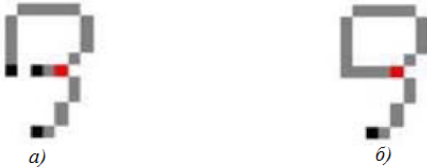
Рисунок 2.6 – Спроба поліпшення зображення символу: а) вихідне зображення символу; б) символ зі склеєними лініями.
