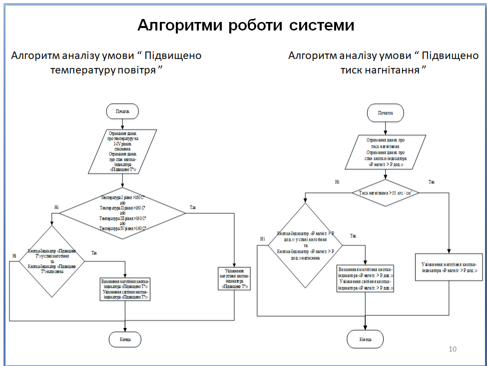
Рисунок Б.10 – Слайд «Алгоритми роботи системи» з алгоритмами аналізу умов «Підвищено температуру повітря» та «Підвищено тиск нагнітання»
