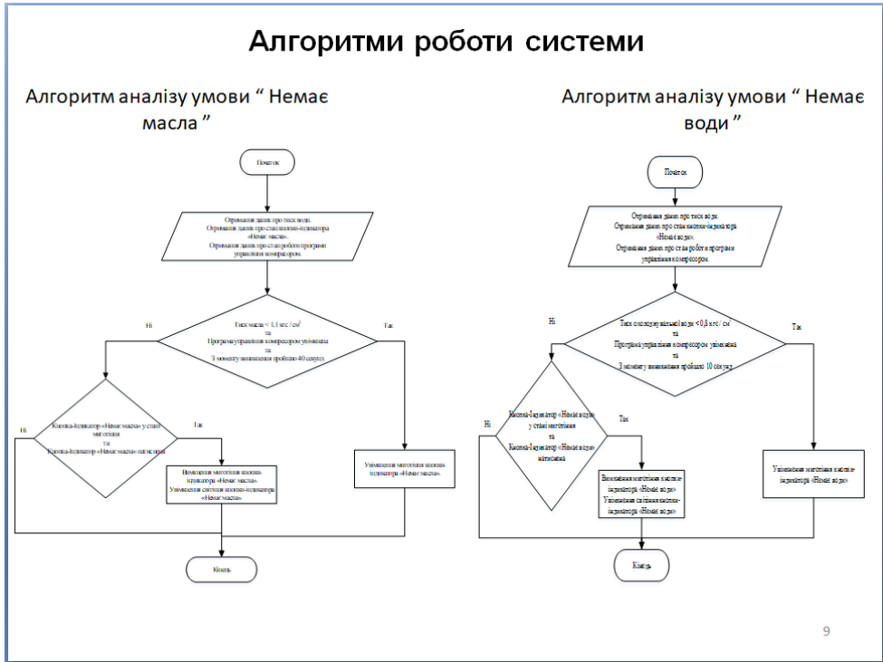
Рисунок Б.9 – Слайд «Алгоритми роботи системи» з алгоритмами аналізу умов «Немає масла» та «Немає води»
