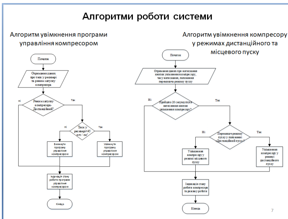
Рисунок Б.7 – Слайд «Алгоритми роботи системи» з алгоритмом увімкнення програми управління та алгоритмом увімкнення компресору
