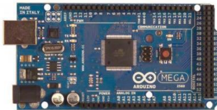
Рисунок 3.5 – Налагоджувальна плата Arduino Mega 2560 (лицьова сторона)
