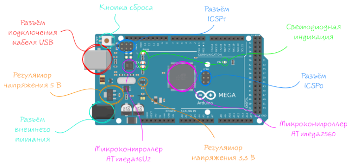
Рисунок 3.7 - Наочне розташування портів на Arduino Mega 2560
