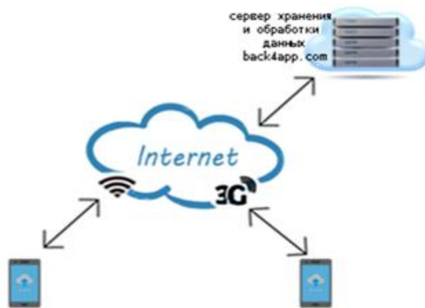
Рисунок 2.6 – Підключення двох користувачів з різними типами з'єднання
