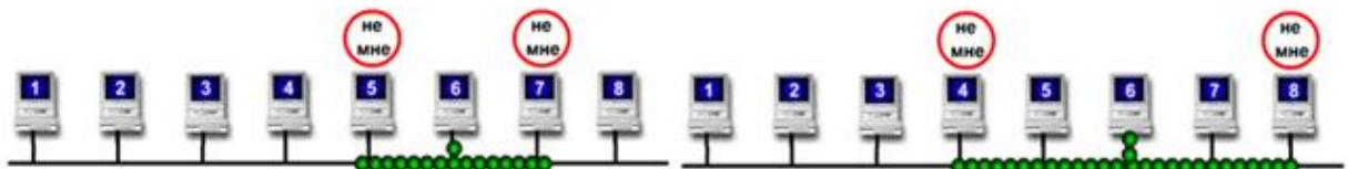
Рисунок 1.3 – Мережа з відсутнім термінатором
