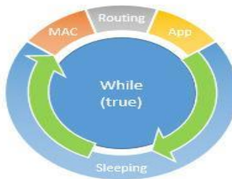
Рисунок 1.6 – Робочий цикл сенсорного вузла БСМ
