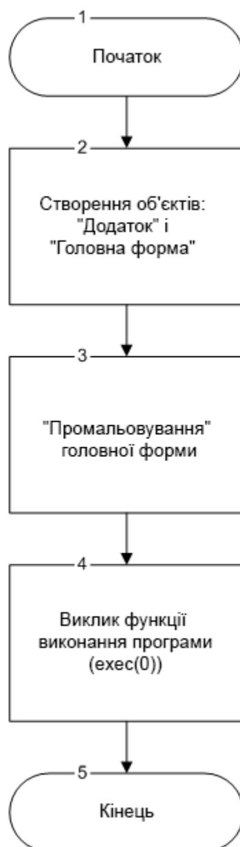
Рисунок 2.17 – Схема алгоритму main-функції програми
