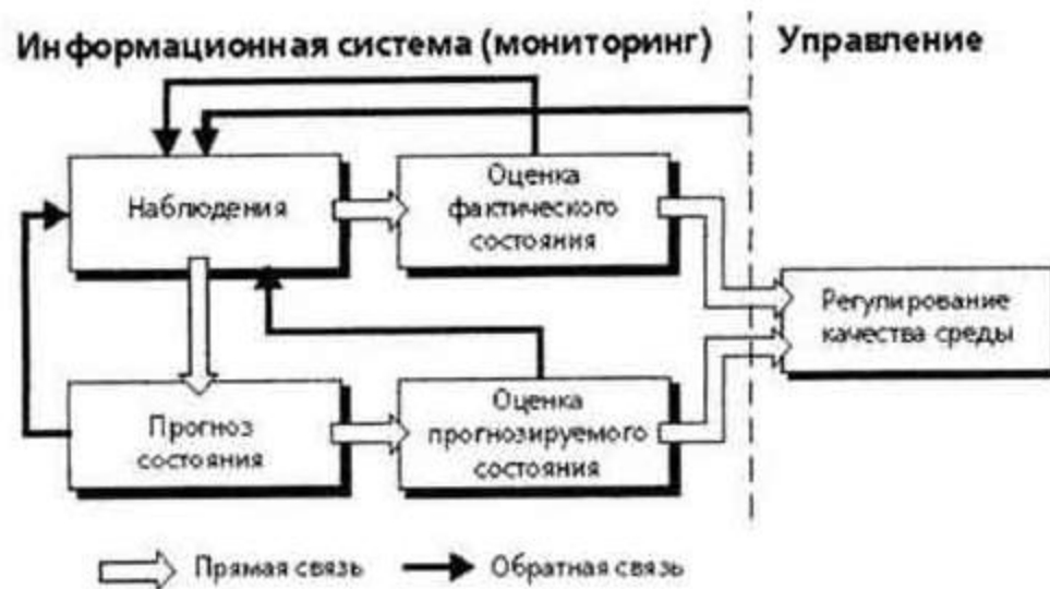
Рисунок 1.5 – Схема інформаційного потоку системи екологічного моніторингу
