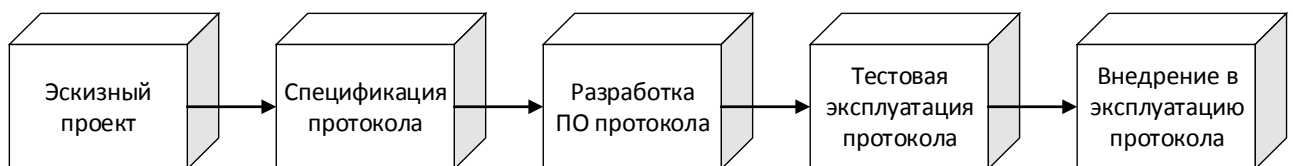
Рисунок 1.5 - Спрощена структура життєвого циклу мережевого протоколу
