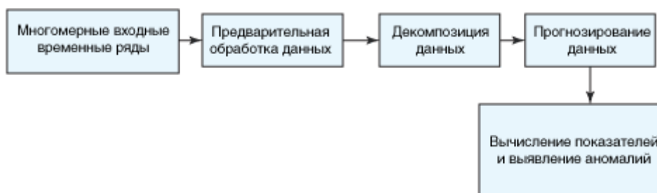
Рисунок 1.5 - Блок-схема этапов процесса выявления аномалий в реальном времени
