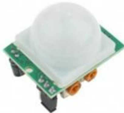
Рисунок 3.3 - Інфрачервоний датчик руху
