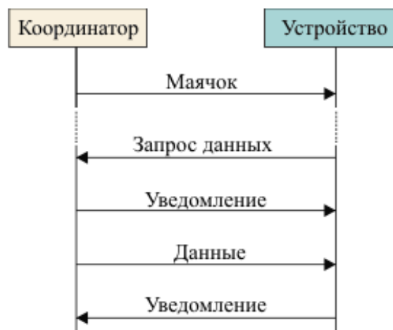
Рисунок 4.3 - Процес передачі даних від координатора до пристрою
