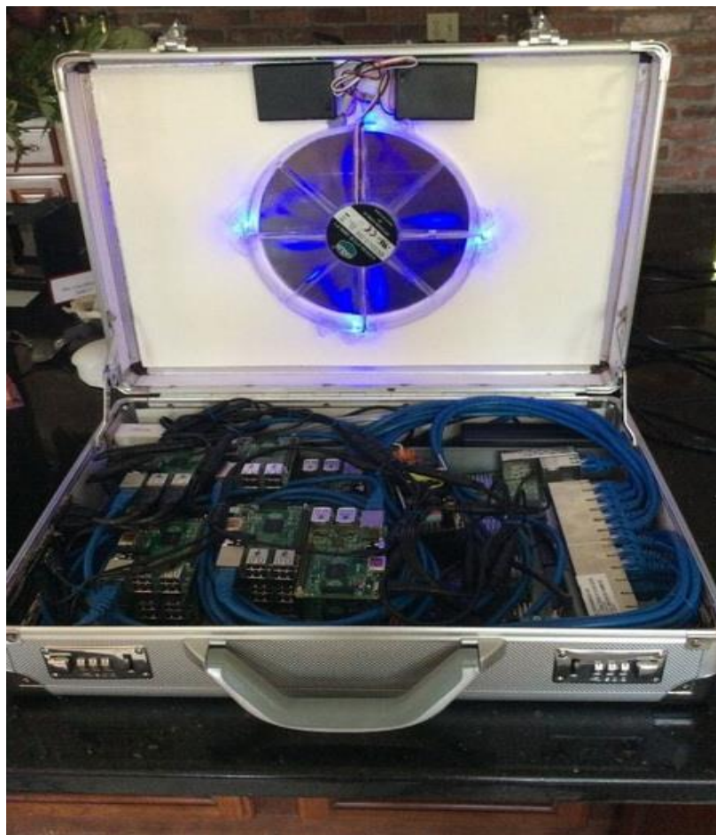
Рисунок 2.2 – Приклад суперкомп'ютера на базі Raspberry Pi2 Model B
