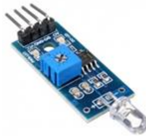
Рисунок 3.1 - Датчик інфрачервоного випромінювання
