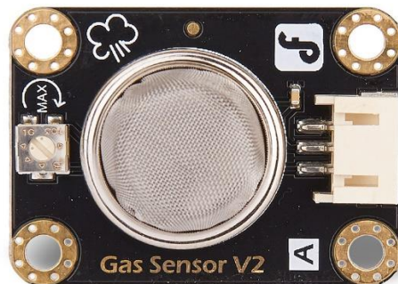
Рисунок 3.2 - Датчик газу MQ-2
