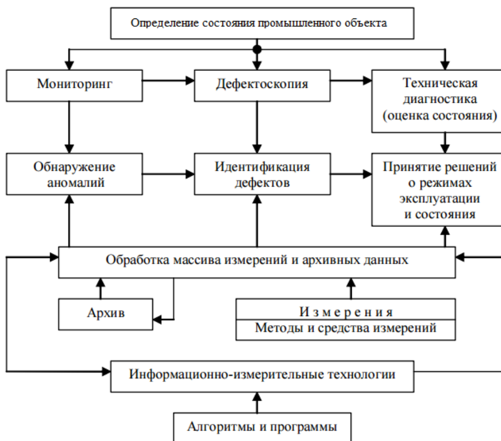
Рисунок 1.6 - Алгоритм визначення стану промислового об'єкта
