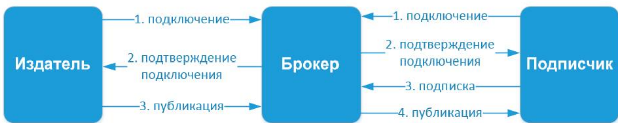
Рисунок 2.4 – Схема простого взаємодії між передплатником, видавцем і брокером
