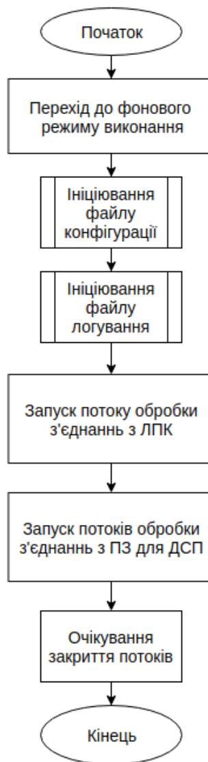
Рисунок 3.1 – Схема алгоритму запуску демону зв'язку
