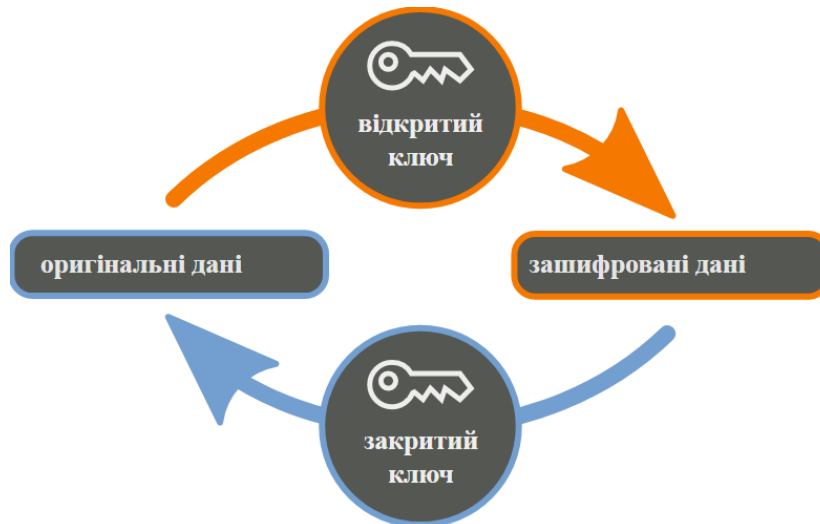
Рисунок 2.4 – Спрощена схема асиметричного шифрування
