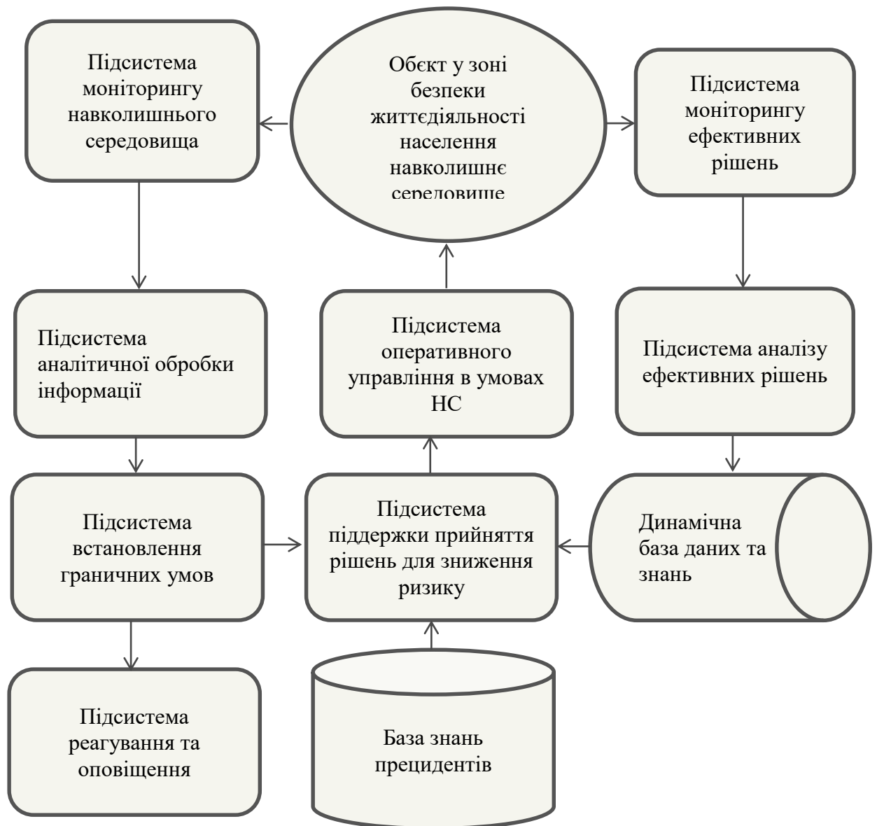
Рисунок 1.4 - Організаційна схема взаємодії основних підсистем в рамках розглянутої технології моніторингу та управління ризиками
