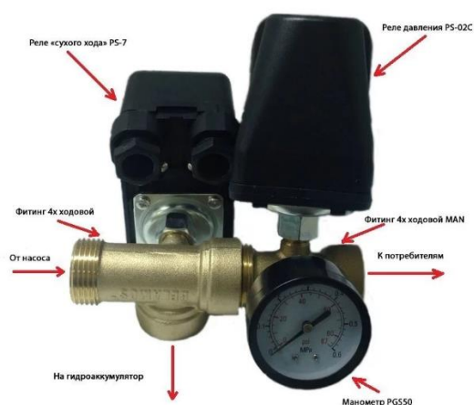
Рисунок 1.1 – Автоматика з захистом від «Сухого ходу» на базі 4-х ходових фітингів Belamos
