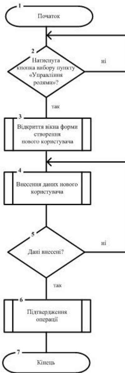
Рисунок 4.3 – Схема алгоритма створення нового користувача
