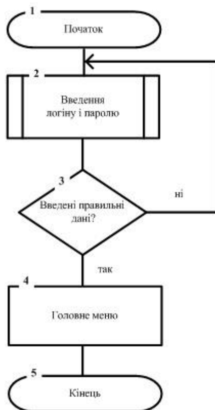
Рисунок 4.2 – Схема алгоритма входу користувача до системи
