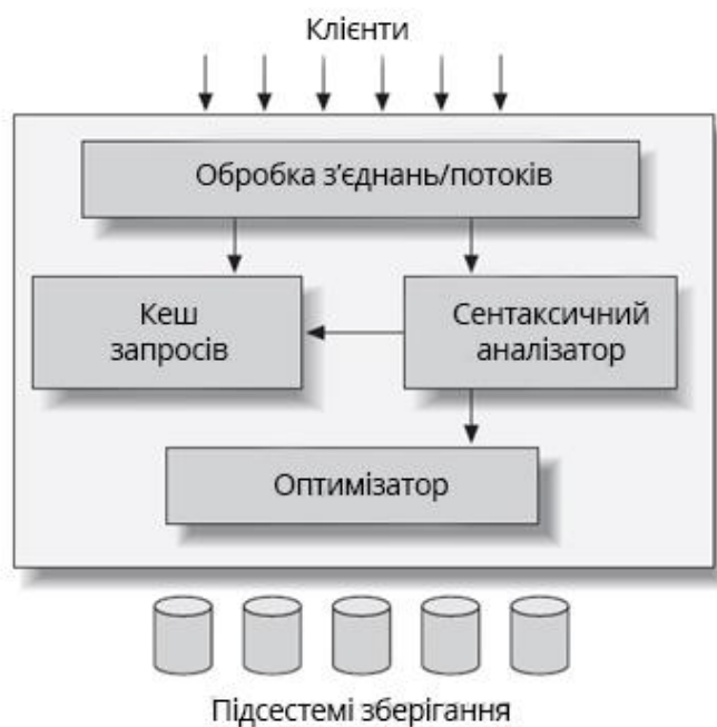
Рисунок 2.3 - Логічна архітектура сервера MySQL
