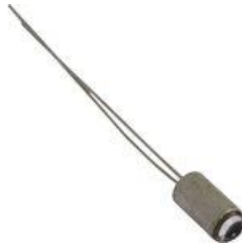
Рисунок 4.2.1 - Зовнішній вигляд фотоелемента ФД256
