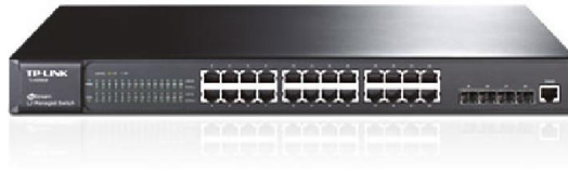
Рисунок 3.1 – Комутатор TP-link TL-SL5428E
