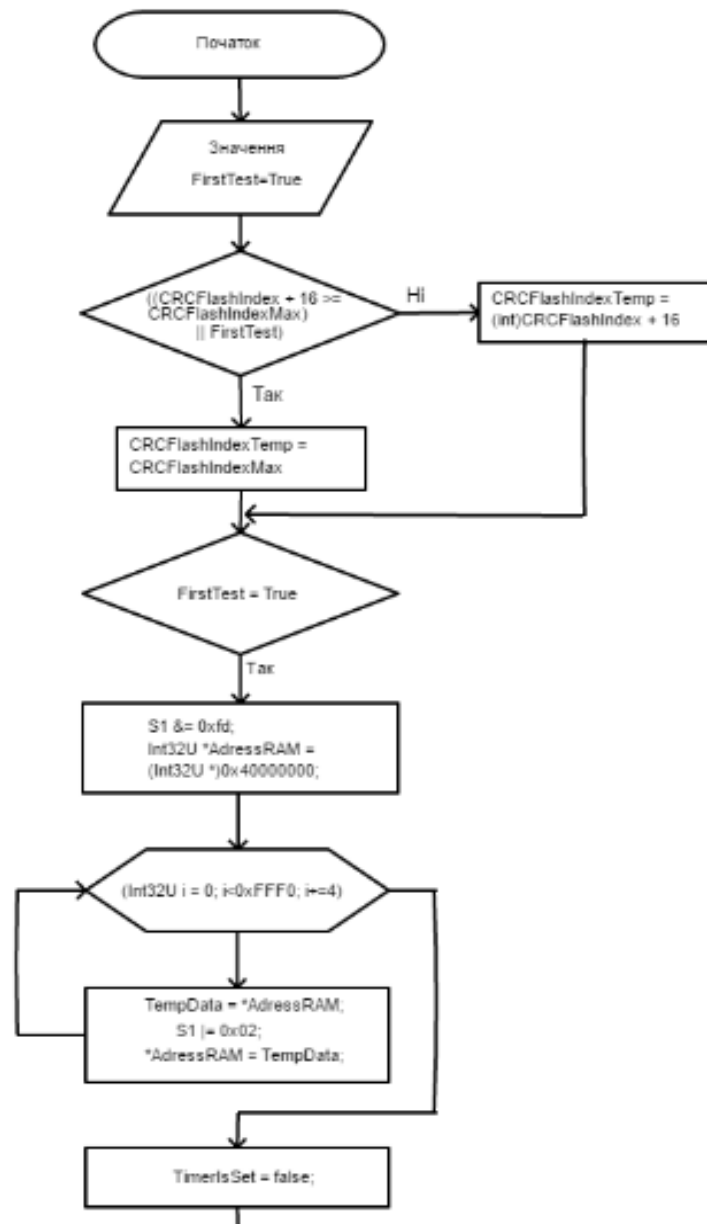
Рисунок 3.2, аркуш 1 - Блок-схема алгоритму підпрограми початкового самодіагностування
