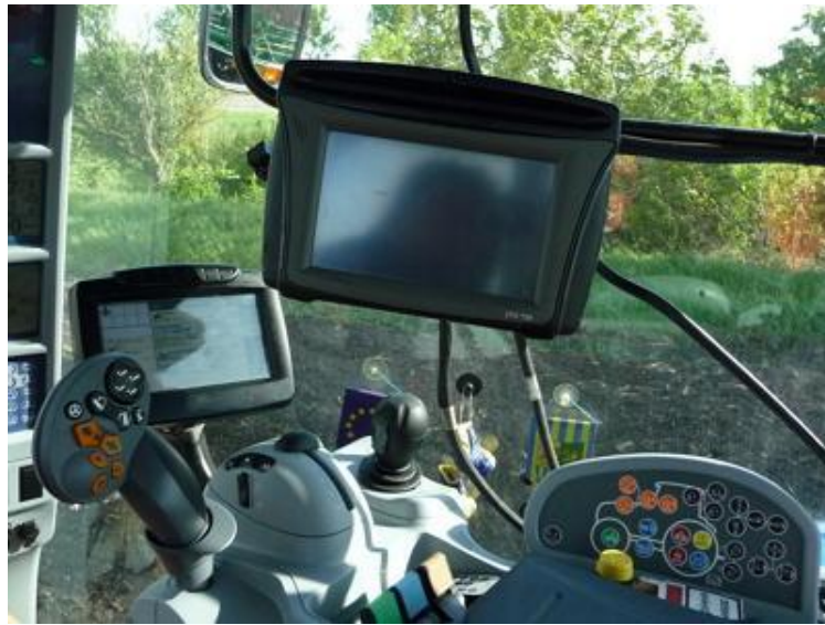
Рис. 1.1 - GPS-навігатор та система автопідрулювання встановлена на тракторі
