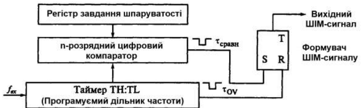
Малюнок 2.4 - Функціональна схема найпростішого ШІМ-генератора
