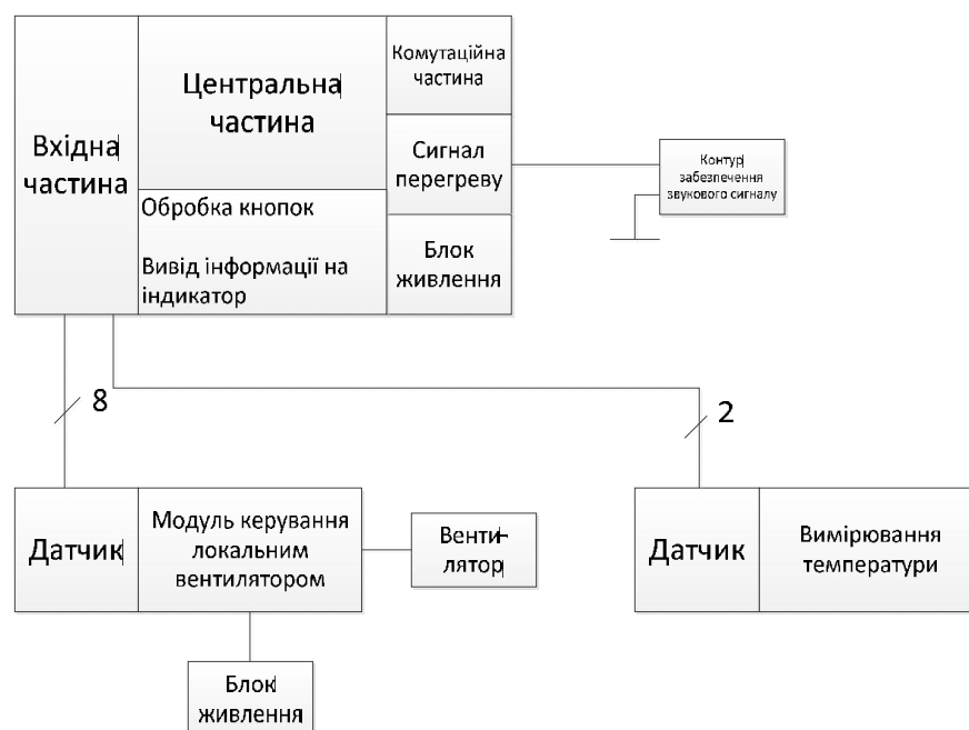
Рисунок 1.9 - Структурна схема пристрою, що розробляється
