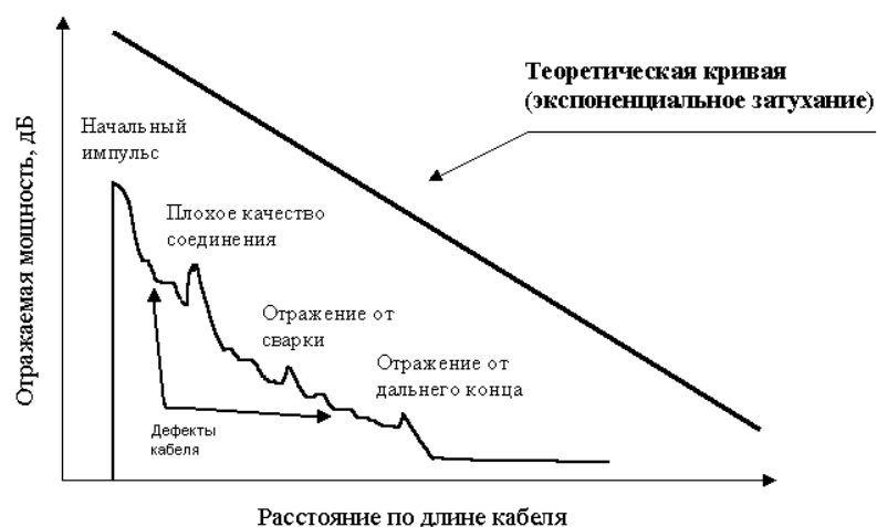
Рисунок 3.3 - Залежність відбиваної потужності від довжини кабелю
