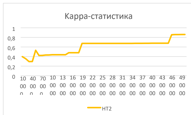
Рисунок 4.7 - Точність алгоритму VFDT з опцією Naive Bayes Adaptive в залежності від обсягу тренувальних даних, отримана в ході експерименту
