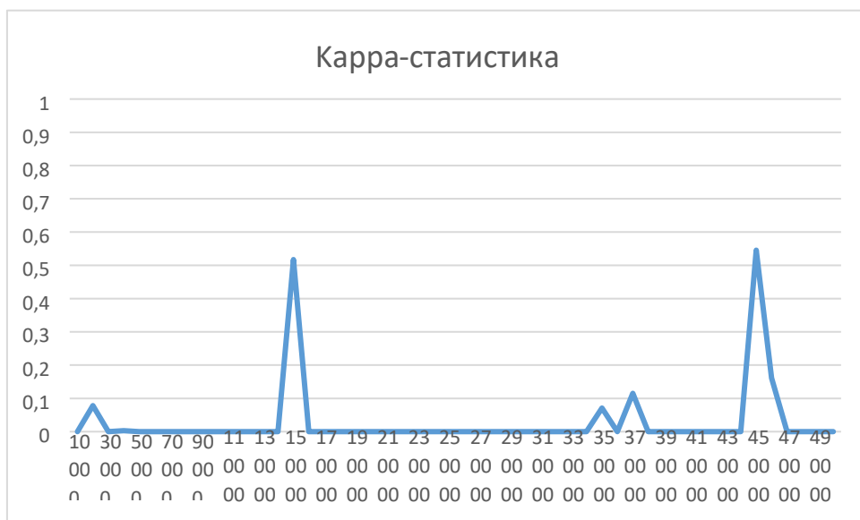
Рисунок 4.1 - Точність методу найближчих сусідів в залежності від обсягу тренувальних даних, отримана в ході експерименту
