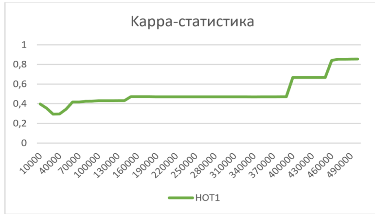
Рисунок 4.12 - Карра статистика алгоритму HOT з опцією Naive Bayes в залежності від обсягу тренувальних даних, отримана в ході експерименту
