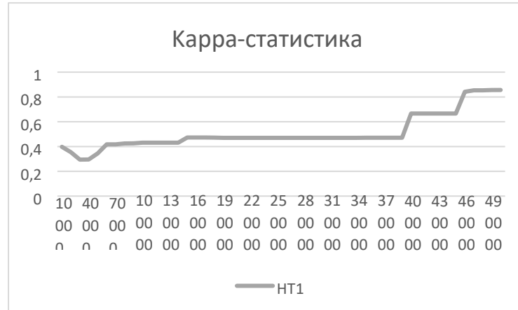
Рисунок 4.6 - Карра статистика VFDT з опцією Naive Bayes в залежності від обсягу тренувальних даних, отримана в ході експерименту
