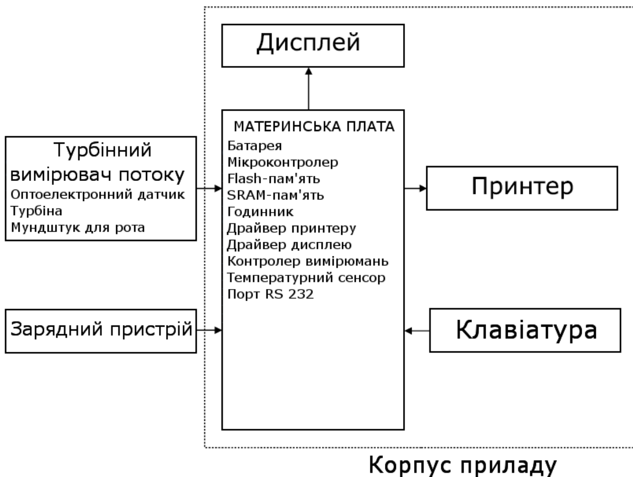
Рисунок 1.5 - Блок-схема спірометра SpiroLab II
