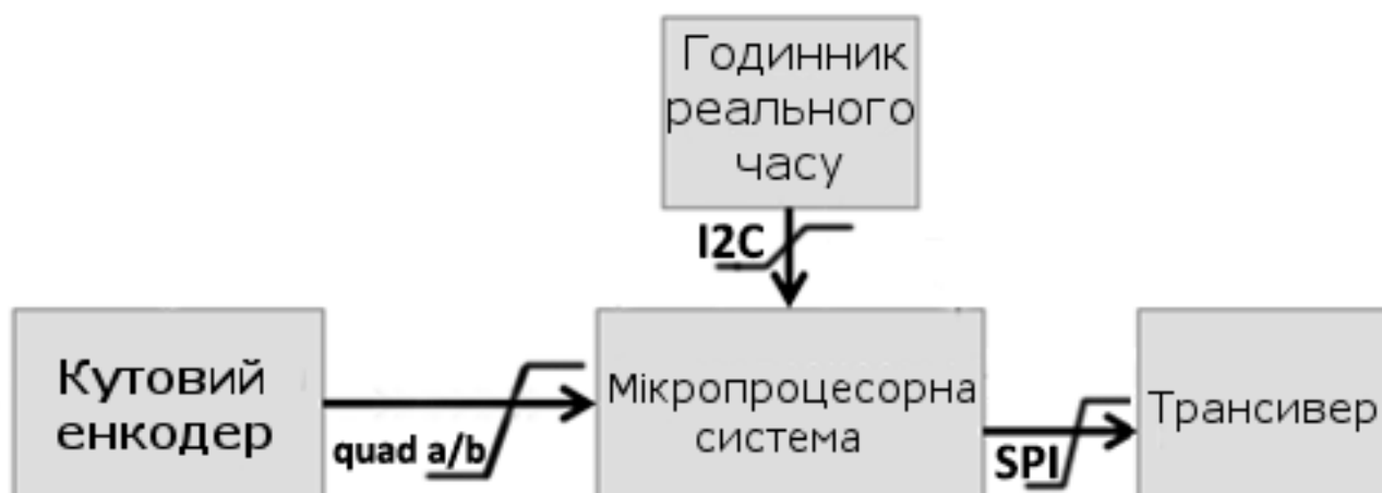
Рисунок 2.1 Схема потоків даних в системі спірометра
