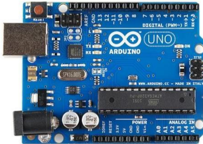
Малюнок 1.2 - Arduino Uno - одна з найбільш популярних плат в сімействі Arduino
